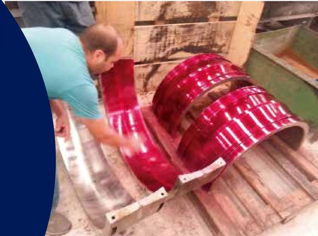
ENSAIO NÃO DESTRUTIVO DE LÍQUIDO PENETRANTE
